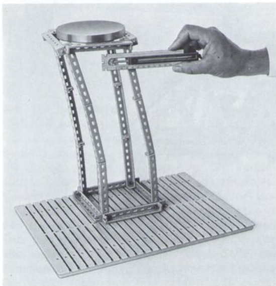
Abb. 23 Ein auf der Grundplatte eingespannter, wenig belasteter „Turm“ ohne Fachwerkausbildung (auch „Gitterung“) ist absolut instabil. Er hält keinem seitlichen Druck (Wind) stand. (Hier ist der Kraftmesser als Druckmesser eingesetzt.)
